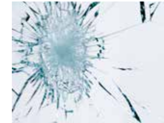
Das Verbund-Sicherheitsglas bricht trotz Gewalteinwirkung nicht auseinander.
