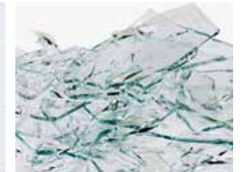
Gewöhnliches Fensterglas zersplittert und der Weg durch das Fenster ist frei.
